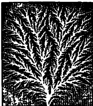
תמונה 8 התפרקות חשמלית בחומר מבודד היא דוגמה לצמיחה של צורה פרקטלית
